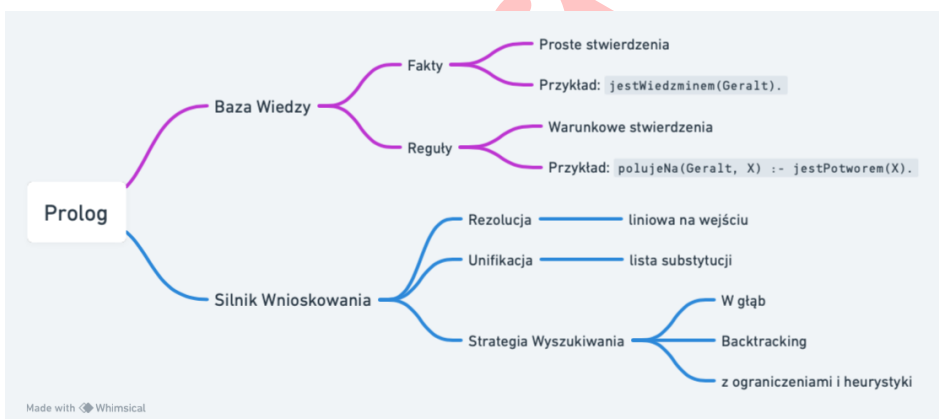
Rys. 10.1: Język programowania Prolog — dwa komponenty (przykłady podane są we właściwej składni języka Prolog a nie logiki predykatów).
